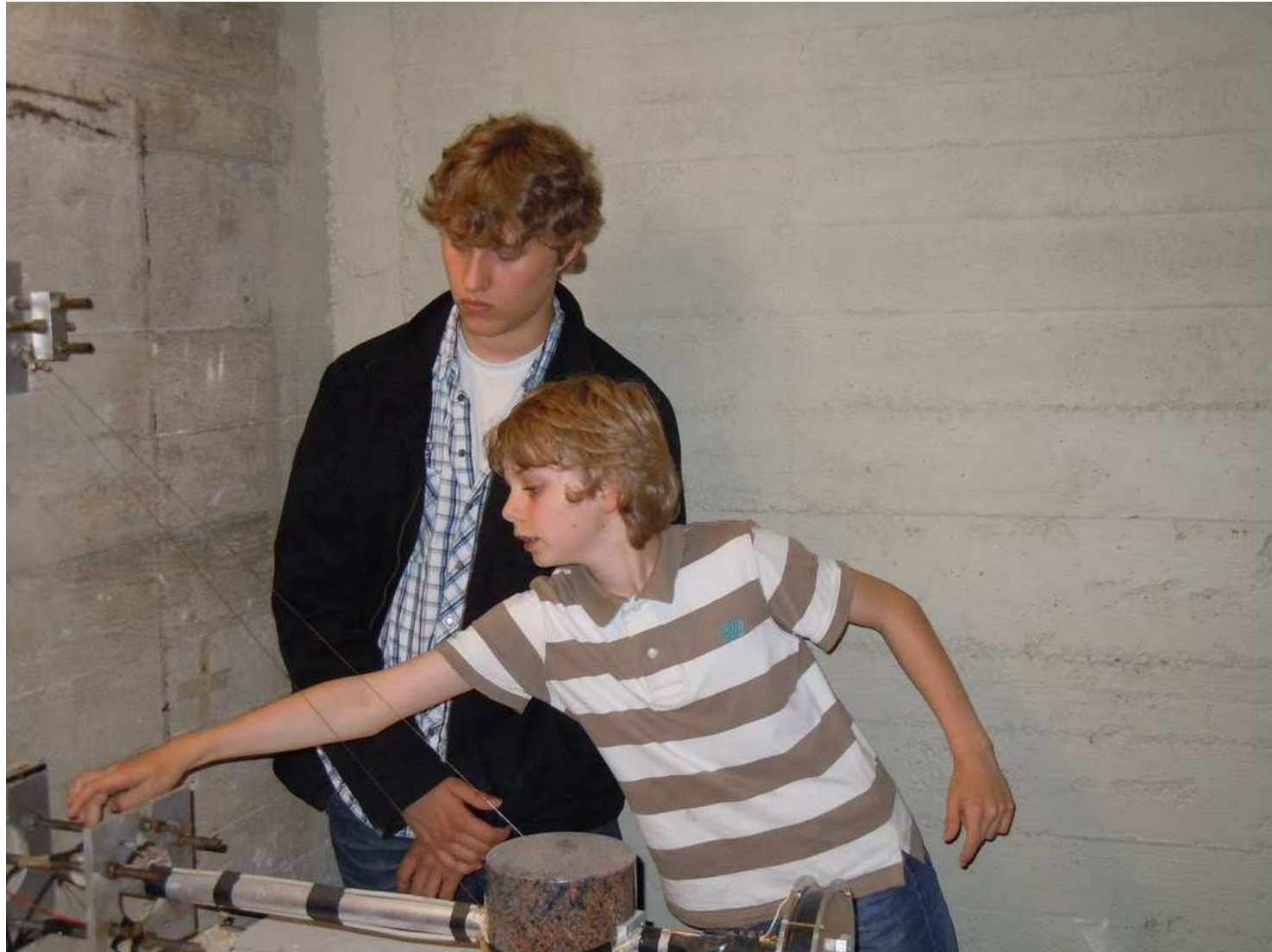
Delano (re.) zeigt durch Zupfen an einem der Lagerungs-Stahldrähte, unter welcher enormen Spannung die Apparatur steht, damit das Gewicht des Pendelkörpers nahezu aufgehoben ist. Johannes Lehtonen (li.) hilft dem Jüngeren, wenn's mal hakt...
